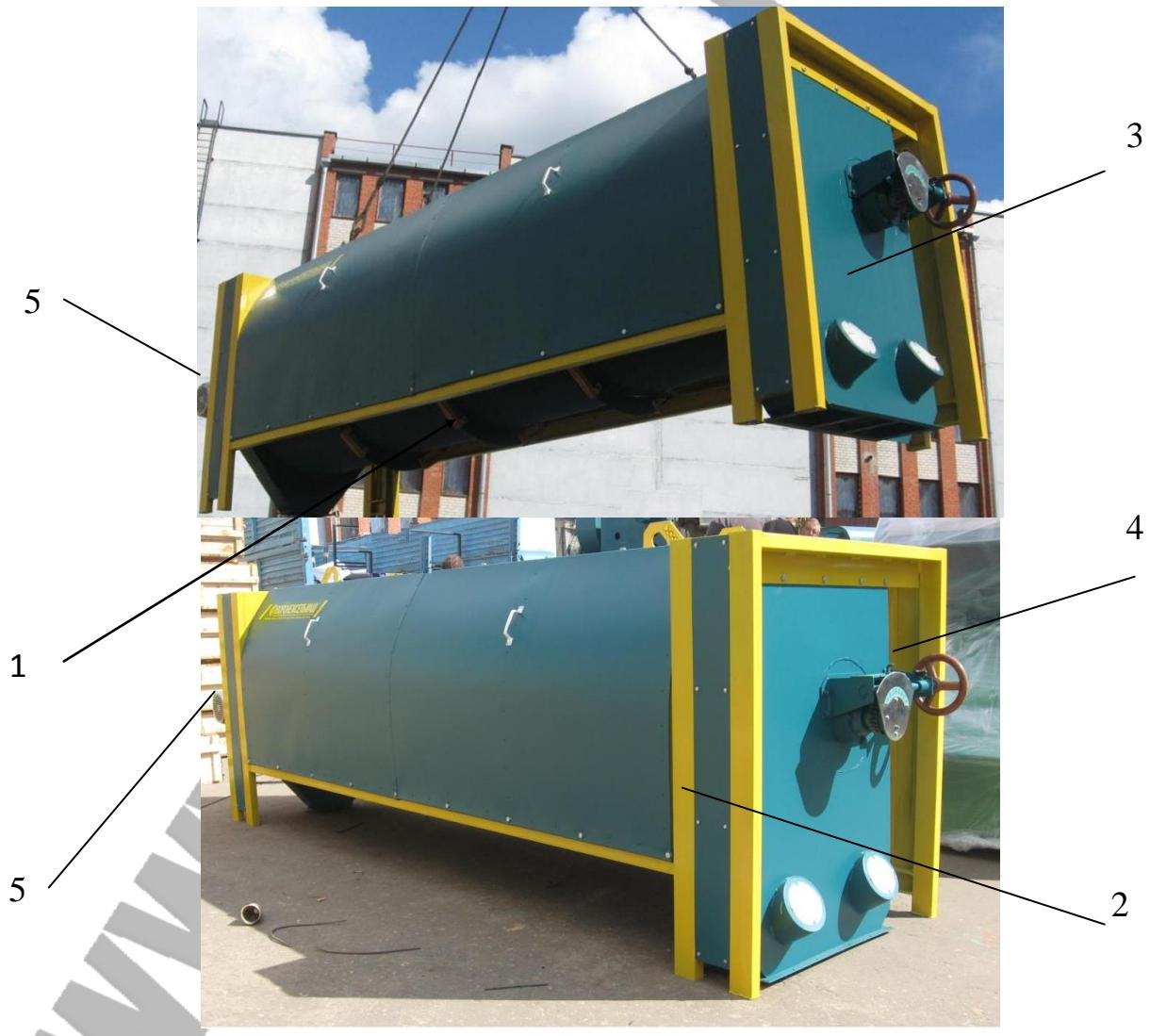
Рисунок 1. Сепаратор триерный СТ-12
