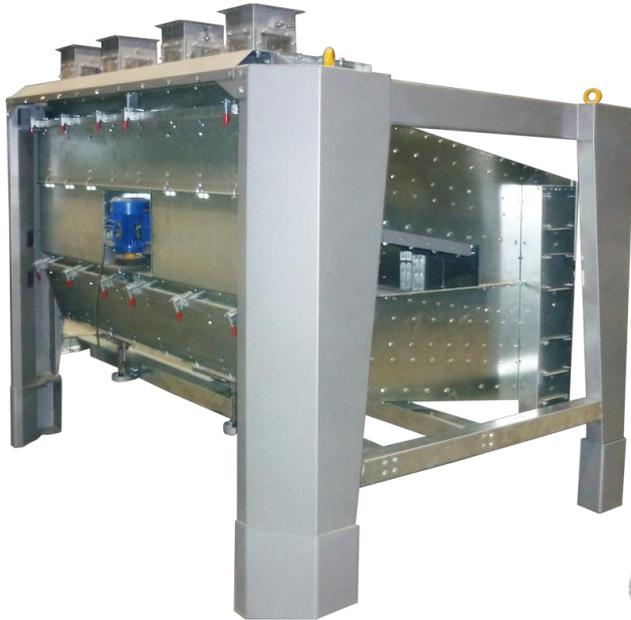
Для отделения от зерна примесей, отличающихся от него шириной, толщиной и аэродинамическими свойствами изготавливаются зерноочистительные (ситовоздушные) сепараторы А1-БИС производительностью 200 т/ч.
